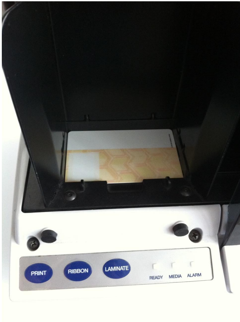
Figura 6: Orientación de carga de sustratos en la impresora P640i
