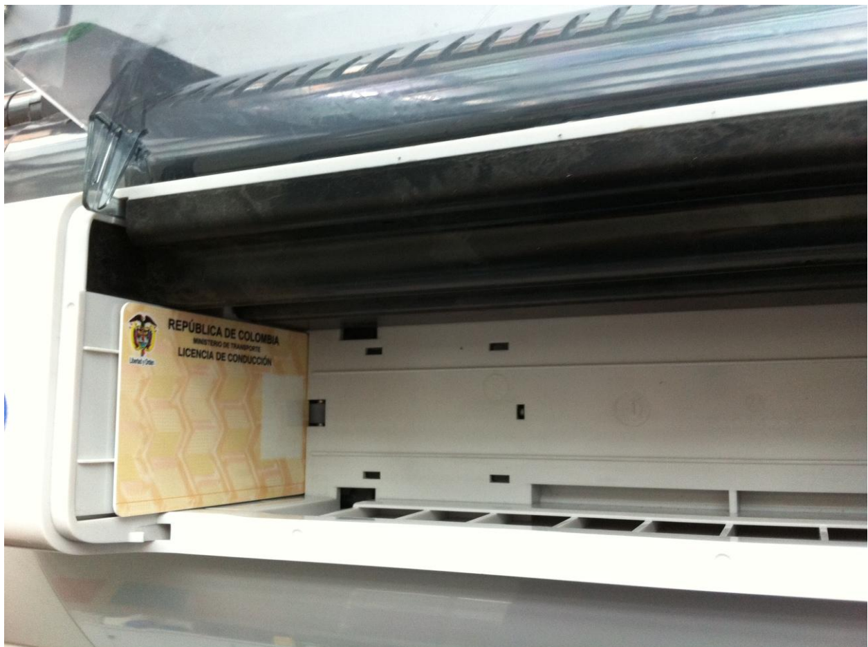
Figura 5: Orientación de carga de sustratos en la impresora ZXP7
